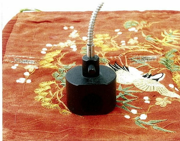
写真3 ファイバーオプティクス先端の照射試料室
