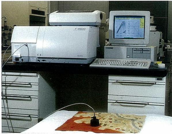
写真2 ファイバーオプティクスを導入した日立製分光蛍光光度計F-4500型と測定風景
