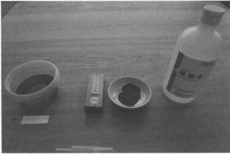
[図21] 右から精製水、墨滴の液滴、エオシン5%水溶液
