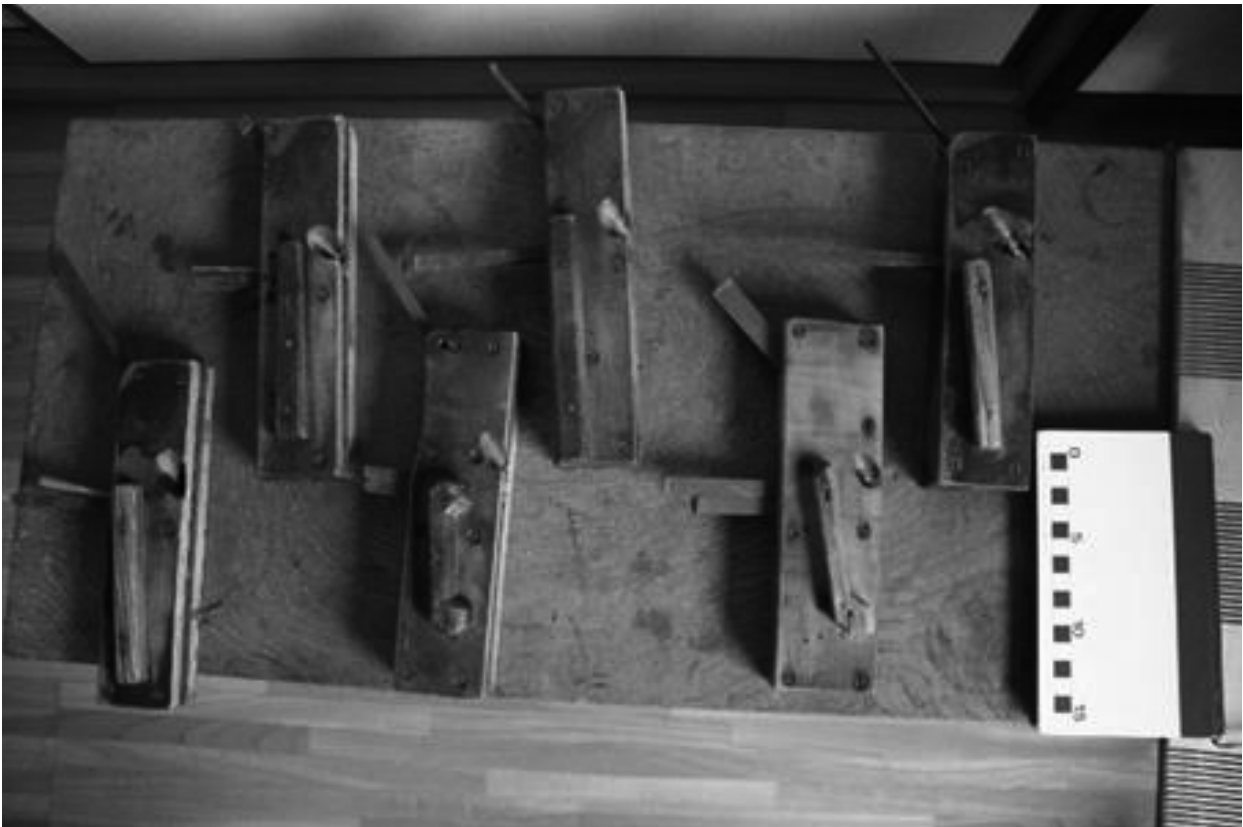
図表 20 板大工が使用した溝切り鉋（株式会社白たか織所蔵）
