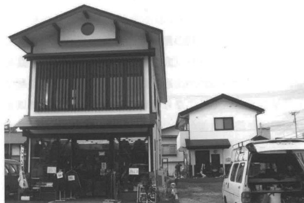
写真3 2階開口部を縦格子に変更した事例(表2の西6)と窓が整理された奥の事例(表2の西5)
